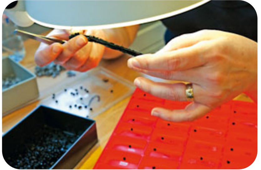
ENTGRATEN VON GUMMITEILEN
