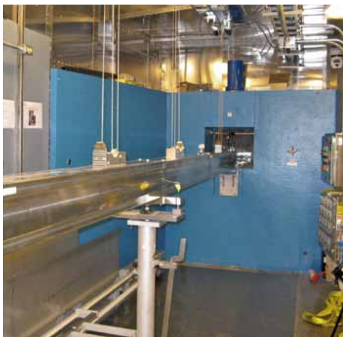
Hochvakuum Abschirmgehäuse, installiert in einem Forschungszentrum (SNS Oak Ridge, USA).
